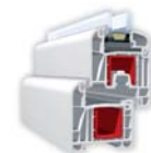
5-komorový systém SELECT so stavebnou hĺbkou 70mm
